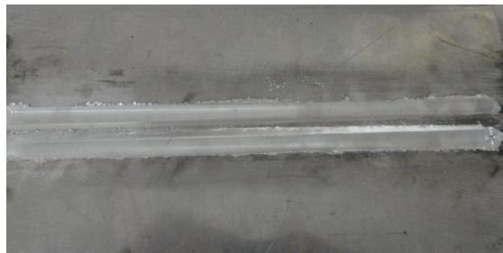
Figura 33. Perfil MIG com reforço e pós-processado
