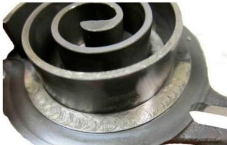
Figura 4.5 – Desgaste intenso da voluta móvel de uma turbina scroll causado pela lubrificação insuficiente (Harada, 2010).
