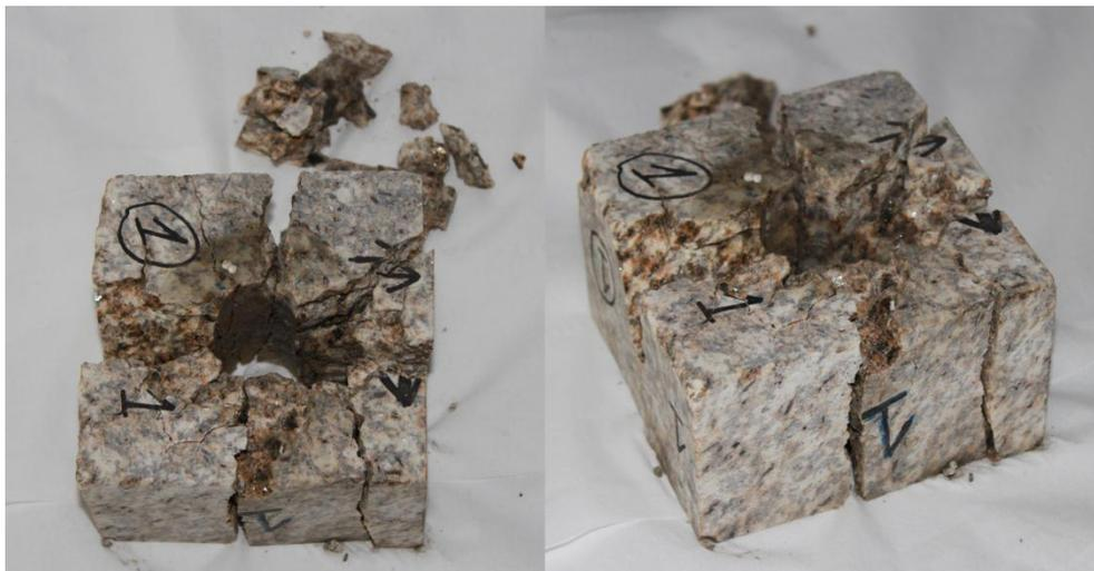
**Figura 5.6.** Resultado da explosão para a amostra 1.
