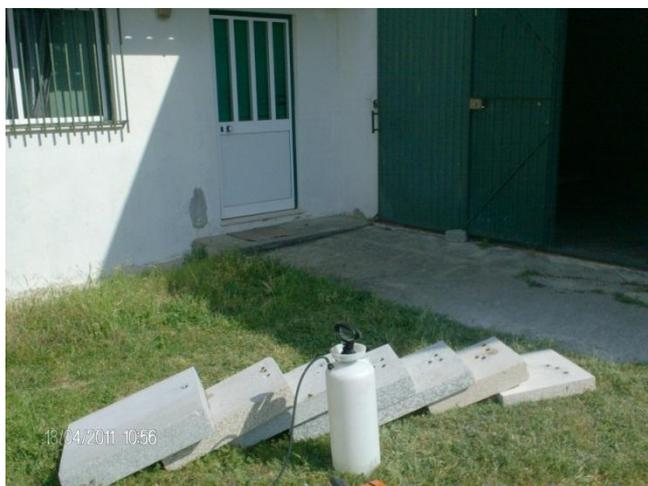
**Figura 4.1.** Disposição dos blocos de granito usados para retirar amostras para os ensaios da ASM.
