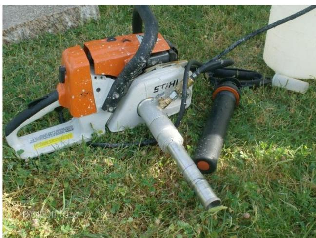
**Figura 4.2.** Equipamento usado para o corte dos testemunhos e reservatório com água para lubrificação da ferramenta de corte.
