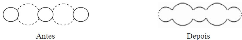
**Figura 3.10.** Esquematisação do processo de corte por perfuração contínua.
