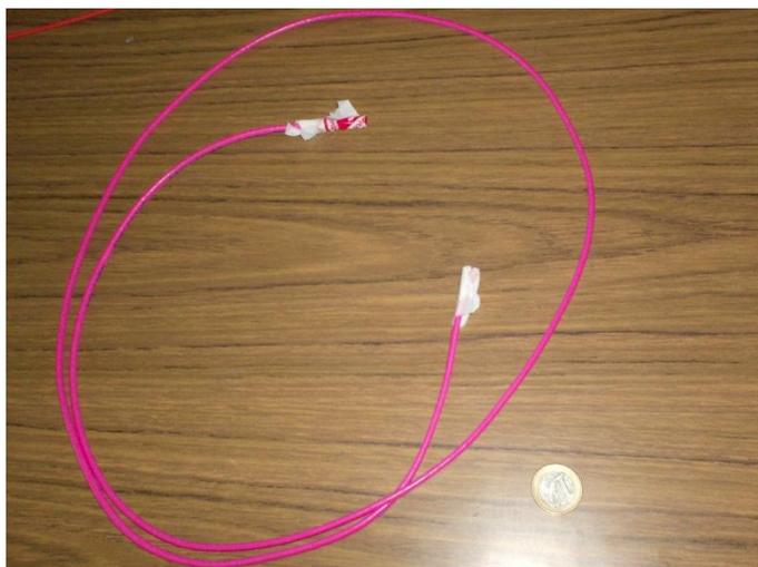
**Figura 5.1.** Cordão detonante de 6 g/m.
