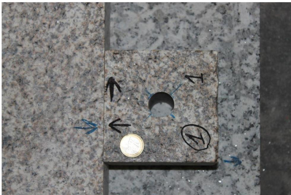
Figura 5.2. Exemplo de amostra com o furo no centro, alinhada com o respectivo bloco.
