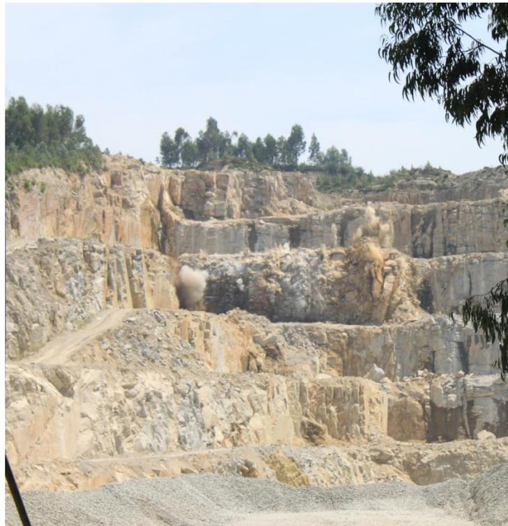
**Figura 3.8.** Rebentamento do maciço por carga explosiva para produção de inertes para construção civil.
