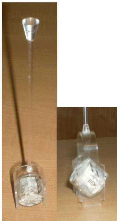
**Figura 4.13.** Instrumento utilizado para fixação das amostras pelo método estático de determinação das ASM.
