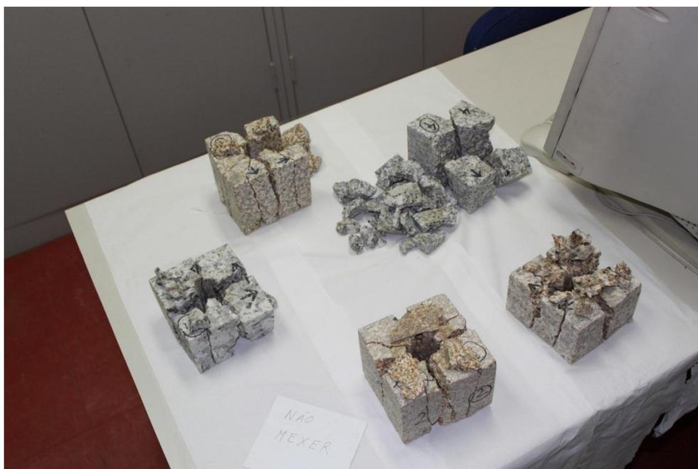
**Figura 6.1.** Visualização das amostras após ensaios com explosivos.
