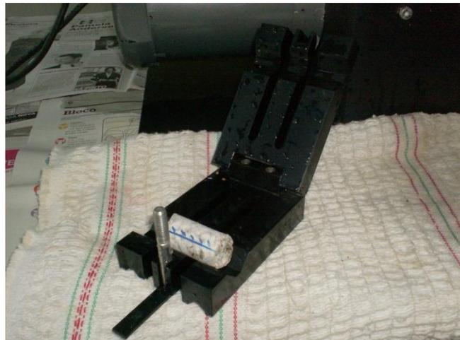
**Figura 4.6.** Mecanismo de fixação dos testemunhos.
