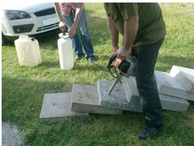
**Figura 4.3.** Processo de corte das amostras para os ensaios da ASM.
