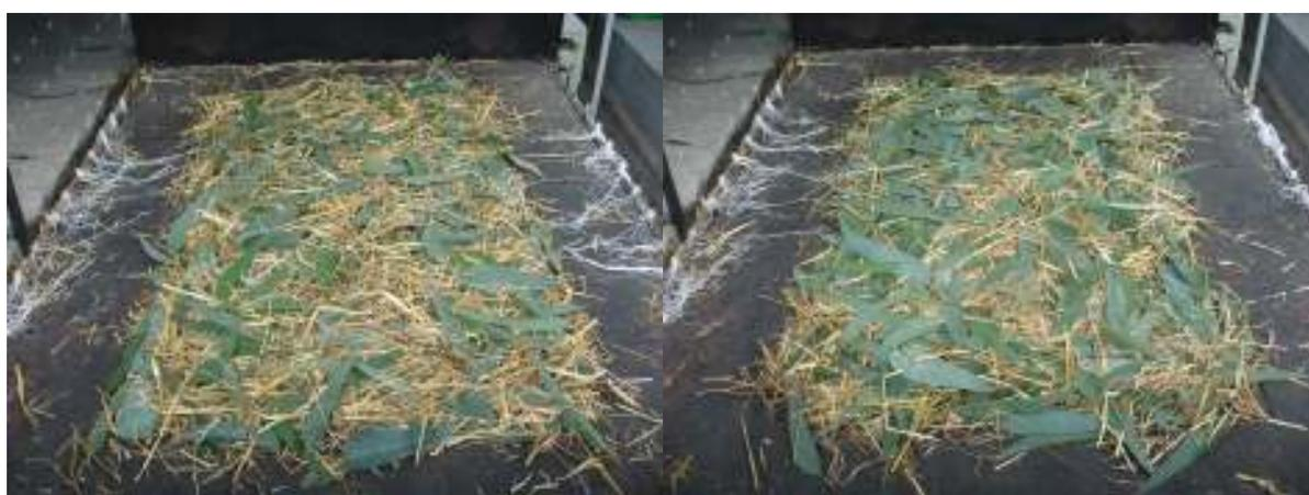
**Foto A.3 – Leito com uma mistura de 30% de palha com 70% de eucalipto (a); leito com uma mistura de 20% de palha com 80% de eucalipto (b).**
