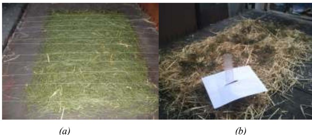
**Fig. 8 – Pormenor da montagem do leito onde se pode observar os fios de algodão utilizados para o calculo da velocidade de propagação, num leito de 100% de pinheiro (a); Metodologia utilizada para medir as alturas do leito (b).**
