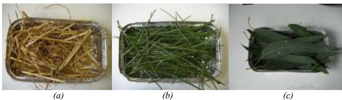
**Fig. 4 – Amostras dos três tipos de combustíveis: palha (a), pinheiro (b) e eucalipto (c) utilizados durante os ensaios.**
