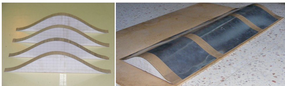
Figura 4 - Placas de madeira utilizadas na construção das colinas (à esquerda), colina construída, modelo 6H (à direita).
