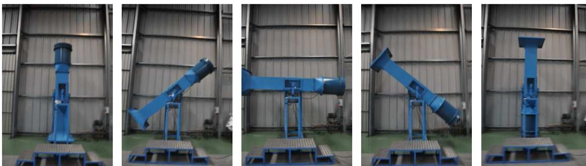
**Figura 8 – Diferentes inclinações do túnel, da esquerda para a direita observa-se 270, 235, 180, 125 e 90°.**
