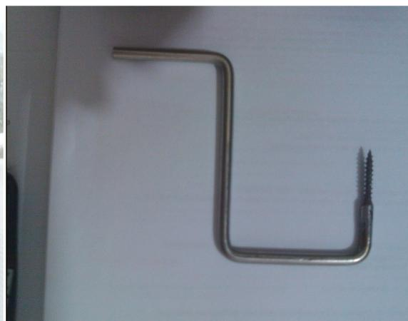
**Figura 25 - Haste de fixação de perfil em "U".**
