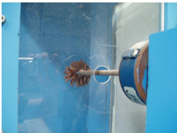
**Figura 10 - Haste de fixação da partícula e célula de carga.**
