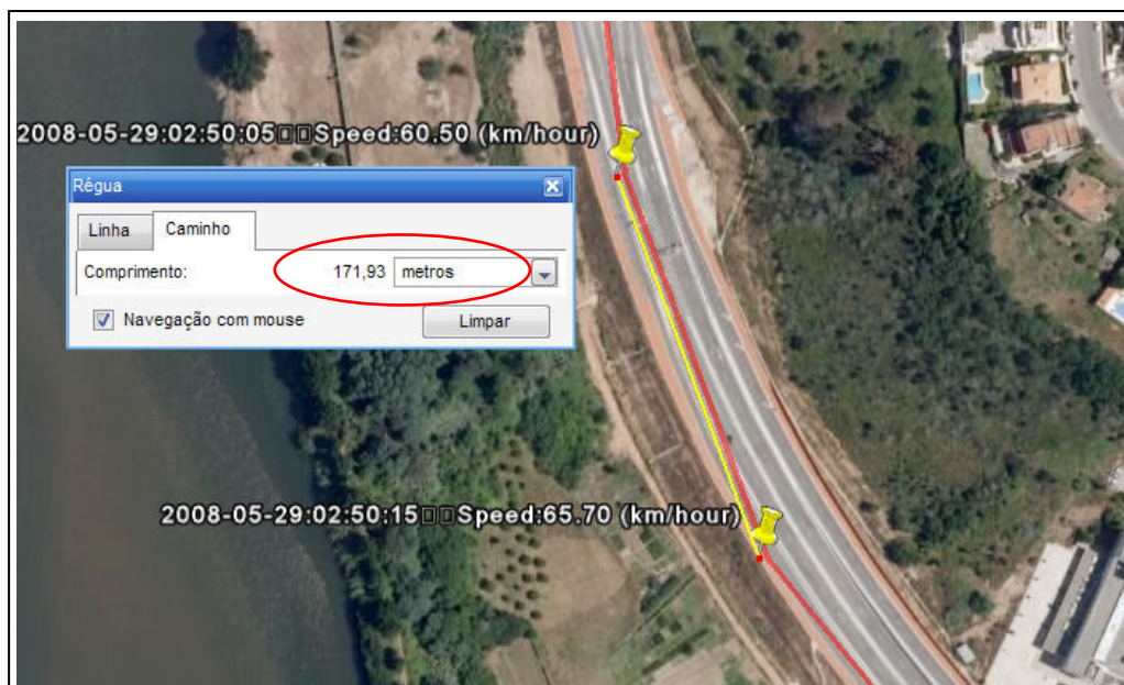
Fig. 8 – Medida entre dois pontos com um intervalo predefinido de 100 metros (medido no Google Earth ® )
