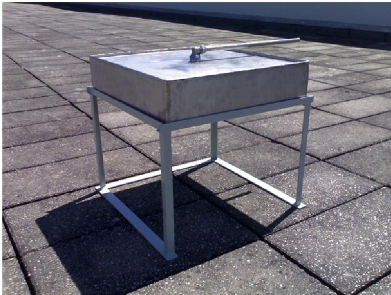
Fig. 17. Evaporador do frigorífico solar montado no suporte.
