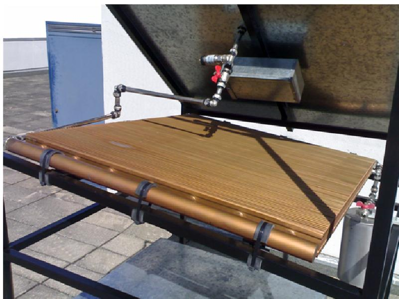
Fig. 13. Condensador do frigorífico solar.
