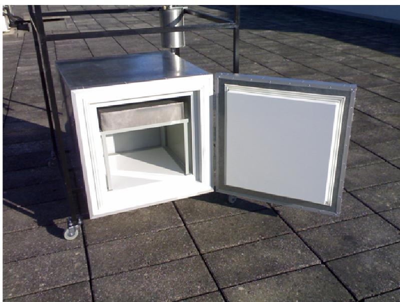
Fig. 19. Câmara frigorífica do frigorífico solar podendo visualizar-se, no seu interior, o evaporador.
