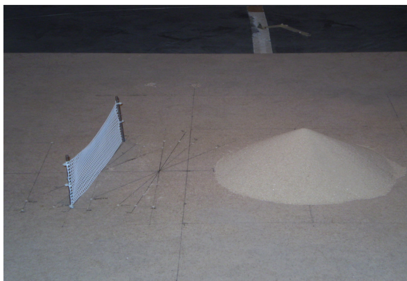
4.10 – Representação da pilha protegida com a barreira colocada com um ângulo de 10°.
