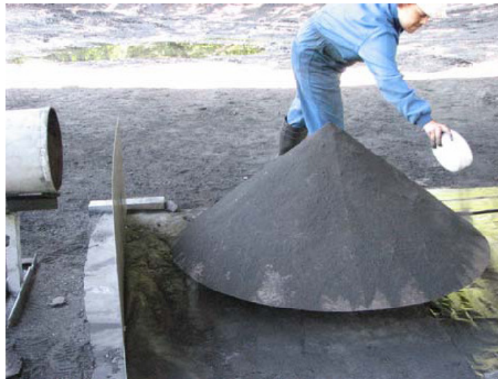
Figura 4.4 – Exemplo de um modelo sólido utilizado no estudo da erosão. (Toraño, 2009).
