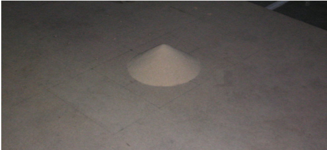
Figura 4.1 – Imagem da pilha sem sofrer erosão.
