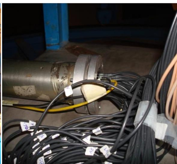
**Figura 4.8** – Scanivalve e numeração das tomadas de pressão.
