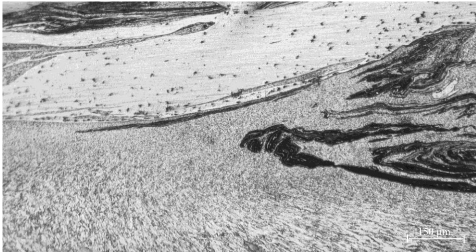
Figura 15 – Variação estrutural do grão de Cobre ao longo da espessura do Nugget da soldadura CL_L-750_16_C_Cu (100x).
