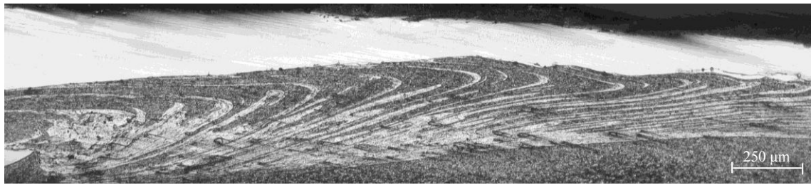
Figura 9 – Estrutura intercalada com configuração em vórtice, referente à soldadura CL_L-750_16_C_Al , (50x).
