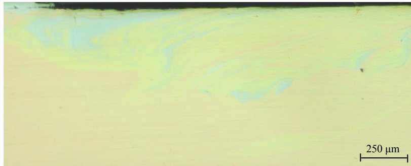
Figura 24 – Estrutura intercalada de tonalidade amarela referente à soldadura CL_L-1000_16_C_Cu (50x).
