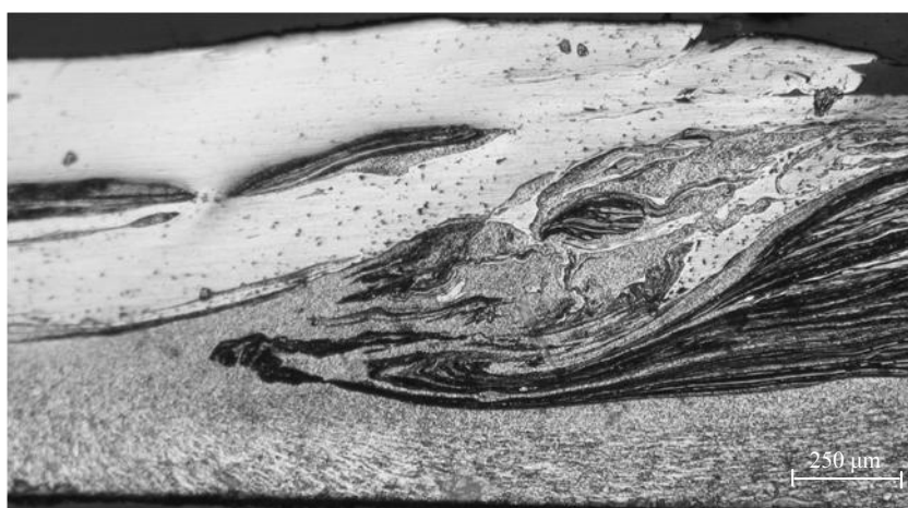
Figura 17 – (a) Fino braço de Cobre penetrante na região do Alumínio da soldadura CL_L-750_16_C_Al (50x); (b) Espessa camada de Alumínio (branco) arrastada para a zona do Cobre (cinzento) da soldadura CL_L-750_16_C_Cu (50x).
