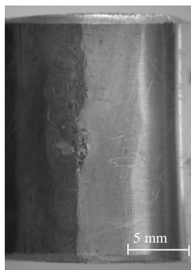
Figura 21 – Ausência de fenda na raiz da soldadura CL_L-1000_25_C_Cu após ensaio de dobragem.
