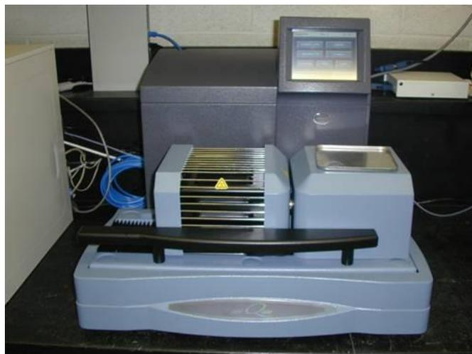
Figura 13 - Equipamento da análise térmica simultânea.
