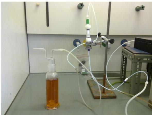
Figura 12 – Instalação do processo de regeneração através da ozonólise.
