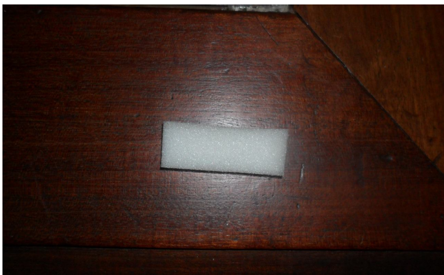
Figura 2 - Esponja sintética usada na absorção de partículas.
