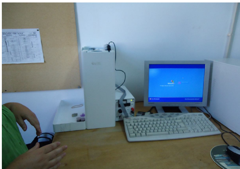
Figura 7 – Magnetómetro rotativo usado na medição da Magnetização Remanescente Isotérmica.
