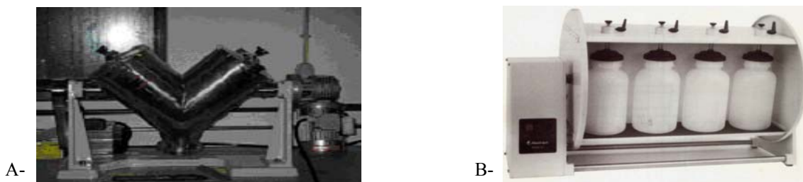
Figura 5.24- Misturadores mecânicos usados na mistura e homogeneização da argila com RCP.
