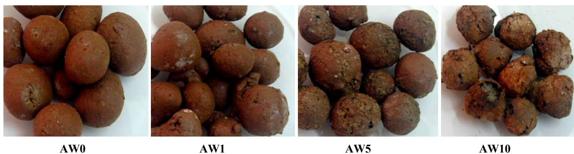
Figura 5.28- Agregados leves do ensaio A, para incorporações de 0% (AW0); 1%(AW1); 5% (AW5) e 10% (AW10).
