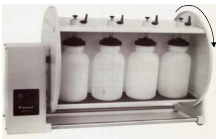
Figura A.3- Agitador Reax 20 –Heidolph, usado nos ensaios DIN 38414-S4. Permite realizar 8 ensaios em paralelo, com uma velocidade máxima de agitação de 16 rpm.
