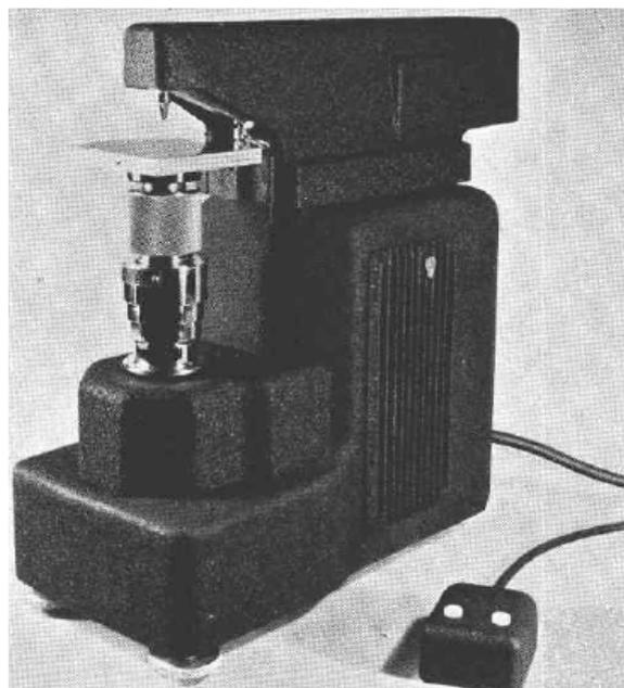
**Figura 1.1.** Máquina de ensaio de dureza Tukon, usando um indentador Knoop (figura retirada de [http://www.minsocam.org/msa/collectors\\_corner/arc/knoop.htm](http://www.minsocam.org/msa/collectors_corner/arc/knoop.htm)).
