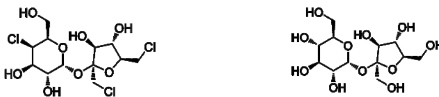
Figura 1.10 - Estrutura molecular da sucralose (esquerda) e da sacarose (direita) evidenciando a substituição de três grupos hidroxilo (-OH) por cloreto (-Cl).
