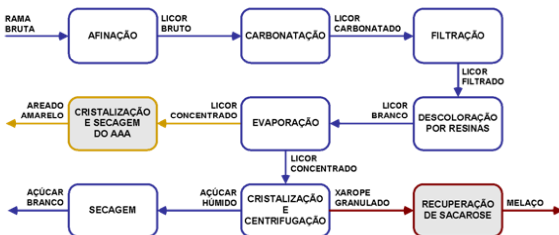
Figura 1.8 - Esquema representativo do processo de refinação realizado na refinaria de açúcar Sidul, em Santa Iria de Azóia.
