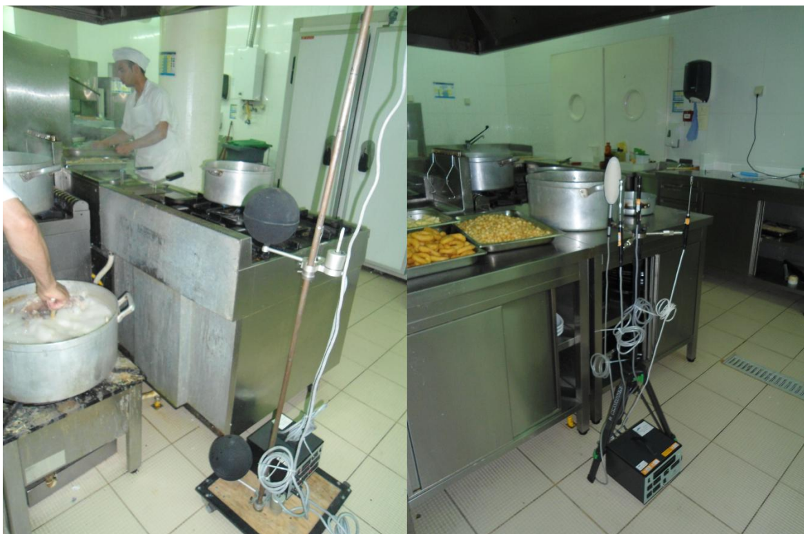
Figura 4.12. Montagem dos equipamentos de avaliação das condições térmicas no estabelecimento C.
