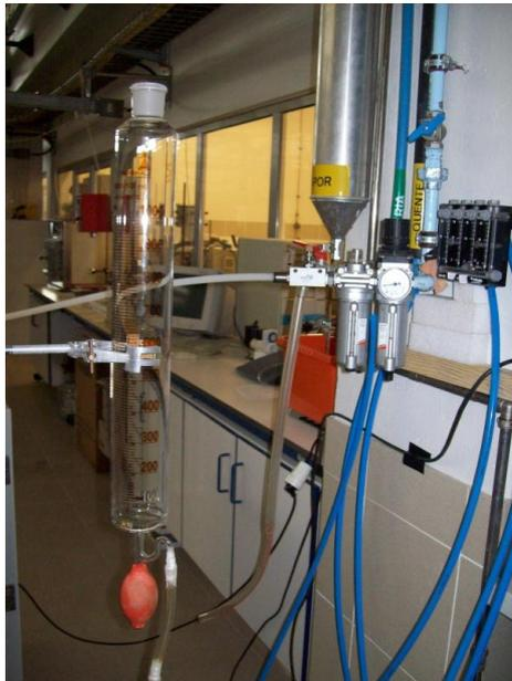
Figura 4.2 - Medidor do caudal de ar (medidor de bolha).
