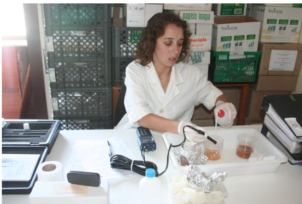
Figura 3.6 -Medição do pH de uma amostra de sedimento.
