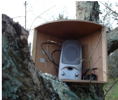
Figura 2.4 – Coluna Sony SRS-A57, com alimentador (pilha de 9V), para reprodução das canções durante as experiências de playback, dentro de uma caixa que direcciona o som.
