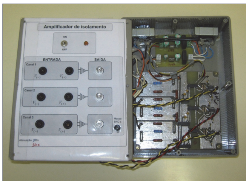
Fig. A-III.1: Vista geral do protótipo laboratorial utilizado para efectuar a medição das tensões (três canais, atenuação de 120×).
