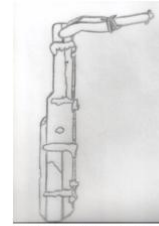
Timone assiale con barra agganciata, assemblato. Restituzione relitto di Cavalaire in Delhaye, 1998
