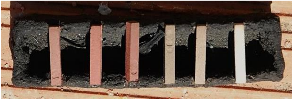
Fig. 174 – Fotografias das mini-barras pirométricas antes e após a cozedura. Esta montagem foi coberta com um recipiente de cerâmica feito propositadamente para o efeito para proteger a montagem do movimento na fogueira. Não se observou deformação das barras que apenas mudaram de cor, provavelmente devido à atmosfera redutora do fundo da cova.
