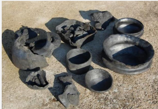
Fig. 130 – Principais fases da experiência 1 – teste B de cozedura com atmosfera rica em carbono e arrefecimento “abafado”.
