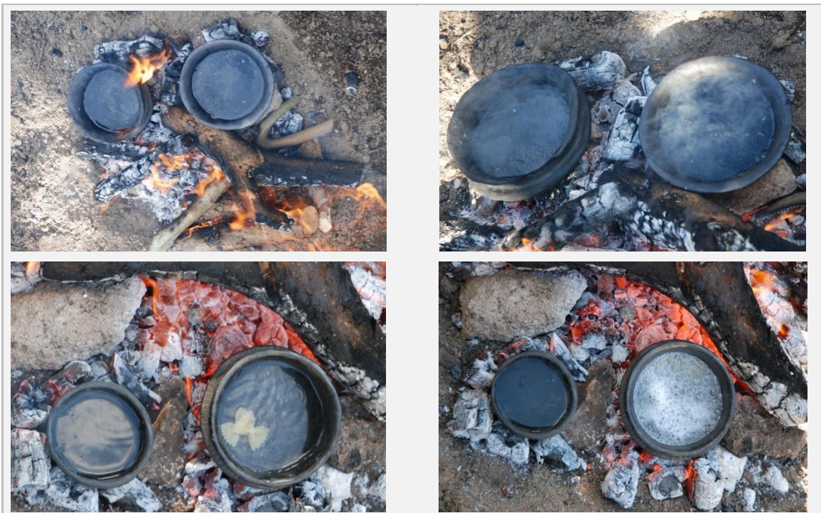
Fig. 133 – Experiência para testar a ebulição com cerâmicas experimentais (Experiência 1) cozidas num ciclo de tempo curto até aos 700°C.
