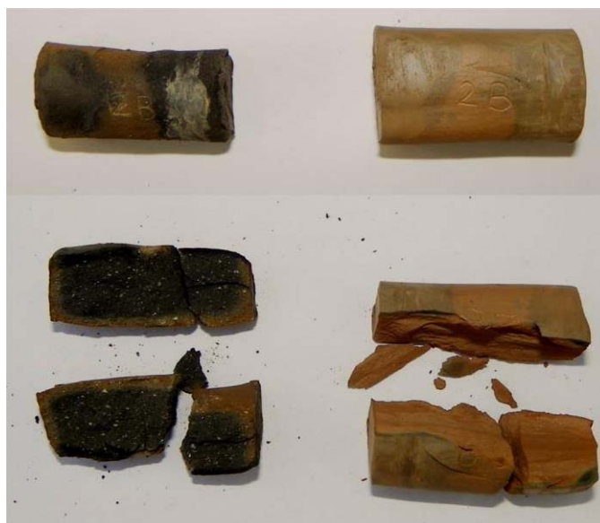
Fig. 127 – Detalhe dos rolos C: cozedura oxidante/redutora faseada até 700°C.
