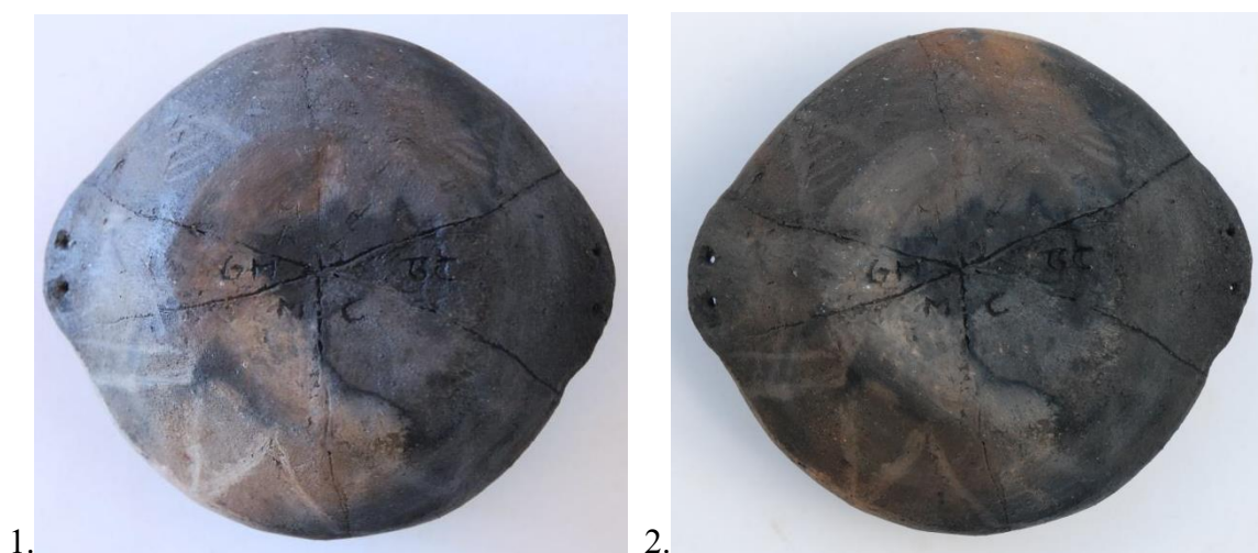
Fig. 120 – Tacinha experimental 134 cuja decoração da metade inferior foi traçada após secagem completa e a superior foi humedecida superficialmente antes de brunir, no caso, com madeira polida e couro. 1. após cozedura; 2. após uso.
