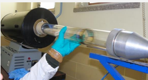
Fig. 122 – Experiência de cozedura: 1. rolos experimentais colocados no tubo do forno; 2. inserção do tubo no forno.
