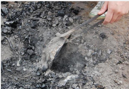
Fig. 128 – Principais fases da Experiência 1 – teste A de cozadura com atmosfera oxidante irregular e arrefecimento “abafado”.
