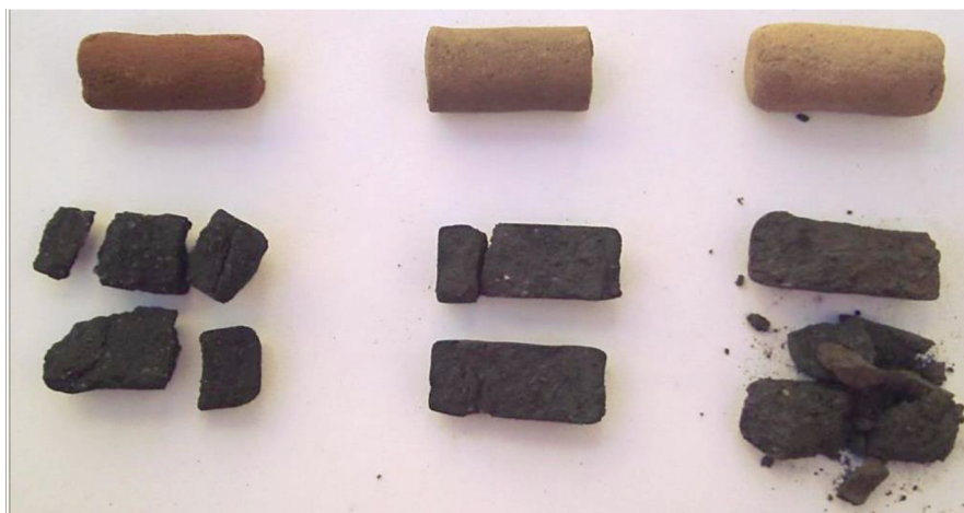
Fig. 166 – Efeitos da atmosfera pobre em oxigênio na cor dos solos de Los Concejiles, Castillo de Alange e Ratinhos.
