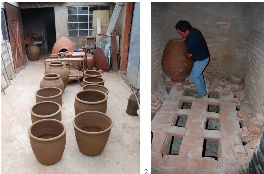
Fig. 109 – Oficina de António Mestre. 1. ordenação da carga no pátio antes da enforna. 2. António Mestre posiciona uma talha dentro da câmara de cozedura do forno.
