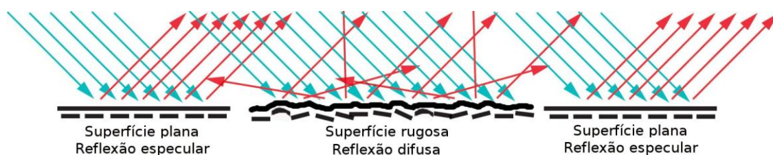
Fig. 6 – Diferenças na reflexão da luz entre superfícies alternadas planas e rugosas.
