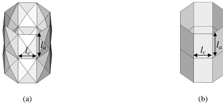
**Figura 7.** Discretização poliédrica do cilindro para  $Ra = 2$  com: (a) elementos finitos triangulares; (b) elementos finitos quadrangulares.
