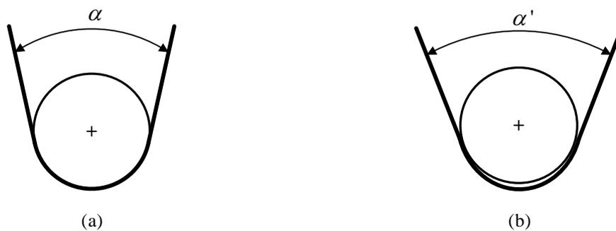
Figura 39. Avaliação do retorno elástico: (a) chapa metálica antes do retorno elástico; (b) chapa metálica depois do retorno elástico.
