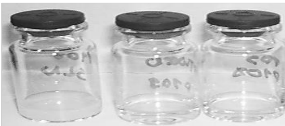
Figura 15. Aspecto final das formulações de nanopartículas produzidas pelo método da evaporação do solvente. O aspecto final das preparações é função quer da natureza do material utilizado na produção da matriz polimérica, quer da solução de hidratação utilizada. Na imagem é possível observar, da esquerda para a direita, formulações reidratadas com uma solução de SLN-Beva, Tween (0,5%) e PBS (pH 7,4). A solução contendo SLN-Beva apresentava turbidez, sendo as restantes translúcidas.
