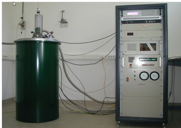
FIGURA 3.8: Montagem do Magnetómetro Squid S700X no ITN.
