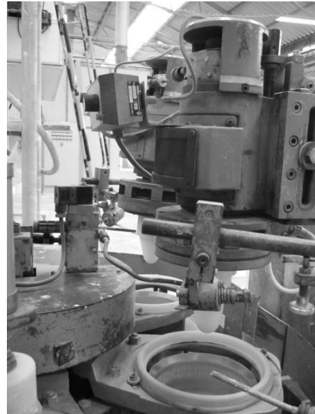
Figura 2.14: Conformação plástica, por roller, a) representação esquemática da conformação interna, b) foto de uma linha de chávenas com duas cabeças de nylon.
