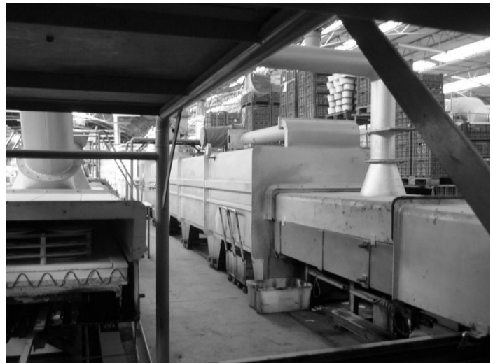
Figura 2.26: Mufla usada na cozedura de peças decoradas.
