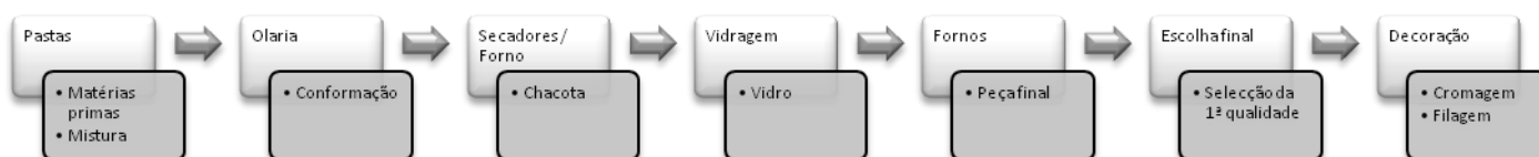
Figura 2.1.: Representação do processo produtivo em função das secções.
