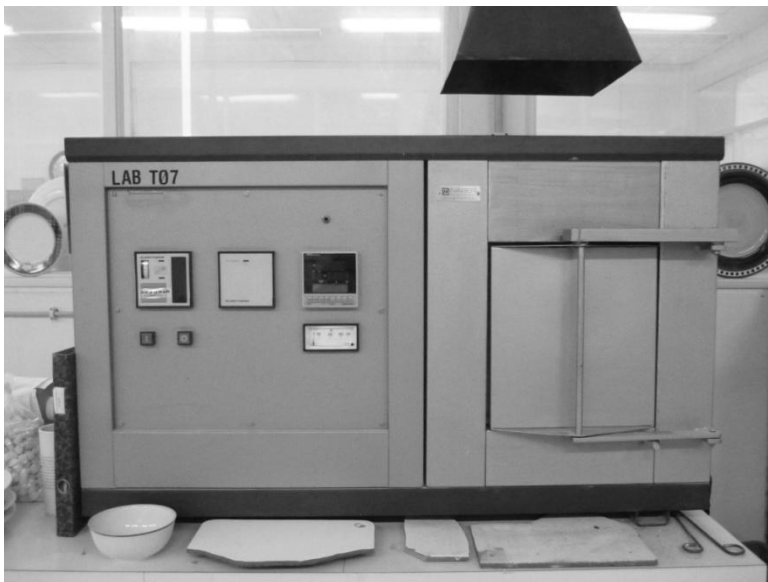
Figura 3.8: Forno de medição do índice pirolástico.
