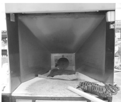
Figura 2.21: Unidade de despoeiramento para limpar as peças antes da vidragem.
