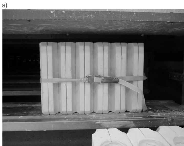
Figura 2.16: Secagem de asas, a) formas horizontais, b) formas verticais.
