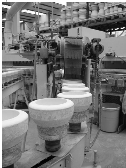
Figura 4.9: Acabamento automático das linhas de chávemas, a) unidade a; b) unidade b
