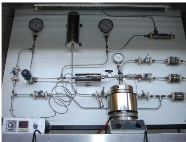
**Figura 4.1** – Linha de gases e reator de alta pressão utilizado em reações de hidroformilação e hidrogenação.
