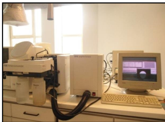
Figura 11 - Espectrômetro de Absorção Atômica em Câmara de Grafite utilizado neste trabalho.
