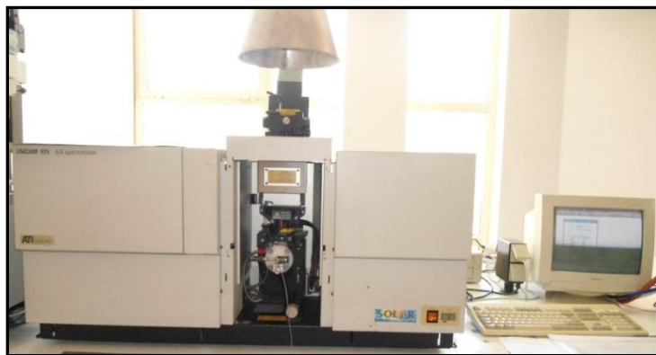
Figura 10 - Espectrómetro de Absorção Atômica na Chama utilizado neste trabalho.
