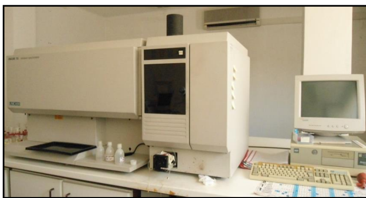
Figura 9 - Espectrómetro de Emissão Atômica com Plasma Indutivamente Acoplado utilizado neste trabalho.
