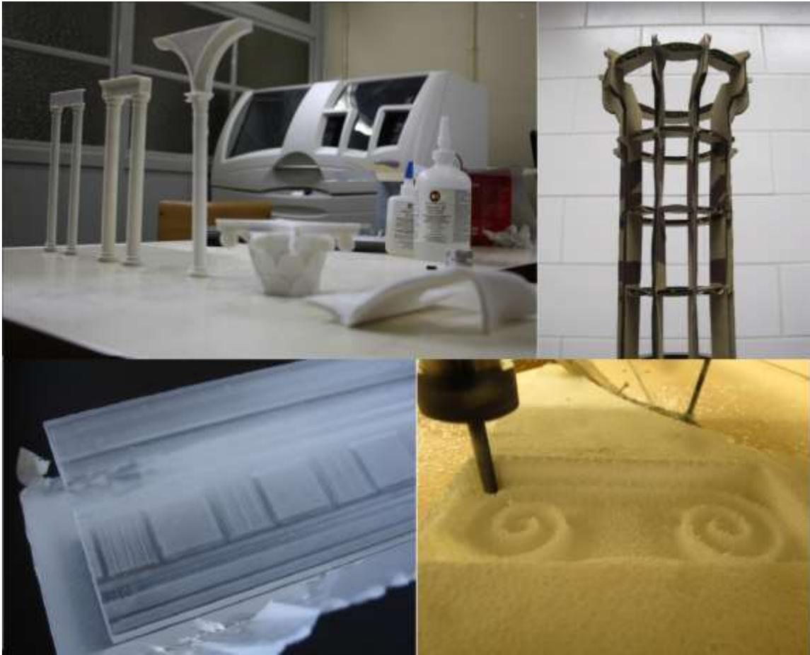
*Figura 11. Modelos fabricados com técnicas de prototipagem rápida com impressora 3D (3DZcorp), coluna fabricada por corte a laser e dois modelos fresados em acrílico e poliestireno expandido.*
