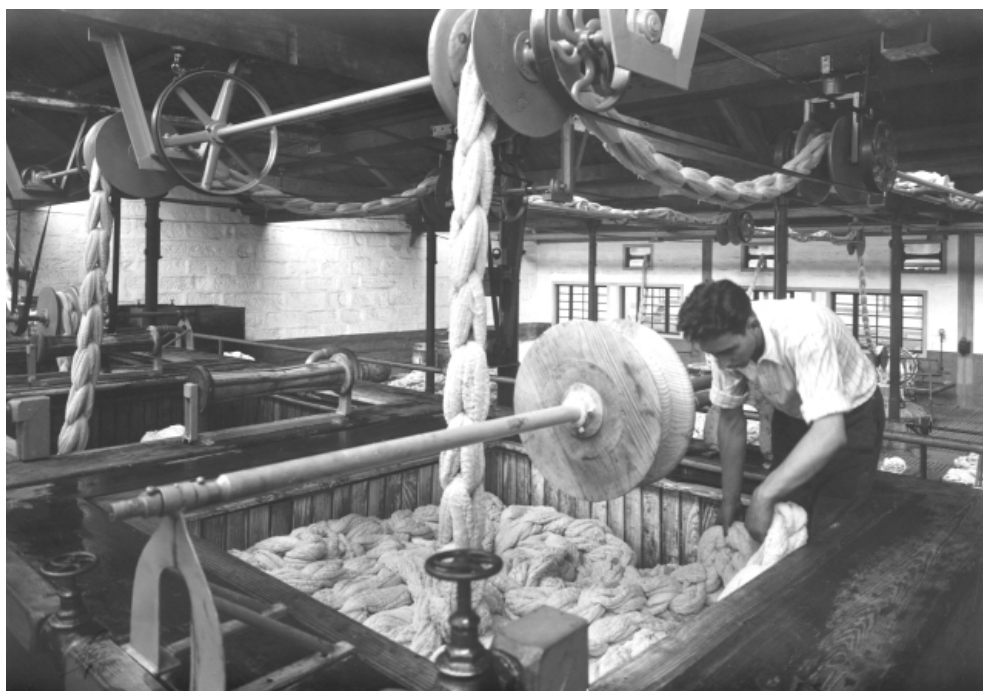
65. Operário a trabalhar em abridor de algodão Fotografia Alvão, [década de 40 do século XX]
