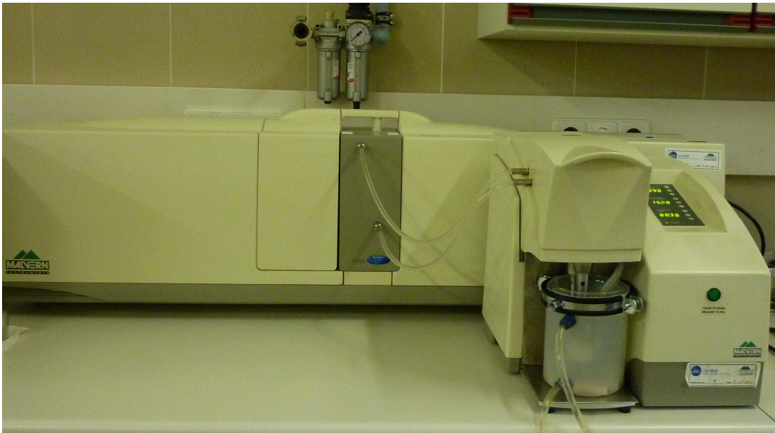
Fig.2.4- Mastersizer Hydro2000 com acessório Hydro 2000MU, utilizado no presente estudo.
