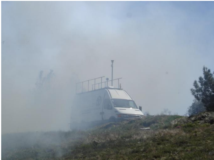
Figura 7. Laboratório móvel de qualidade do ar exposto à coluna de fumo proveniente da queima de uma parcela durante o ensaio “Gestosa 2009”
