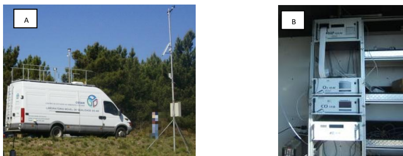
Figura 6. Laboratório móvel de qualidade do ar (A); Analisadores de PM_{10} , CO, NO_x (B)
