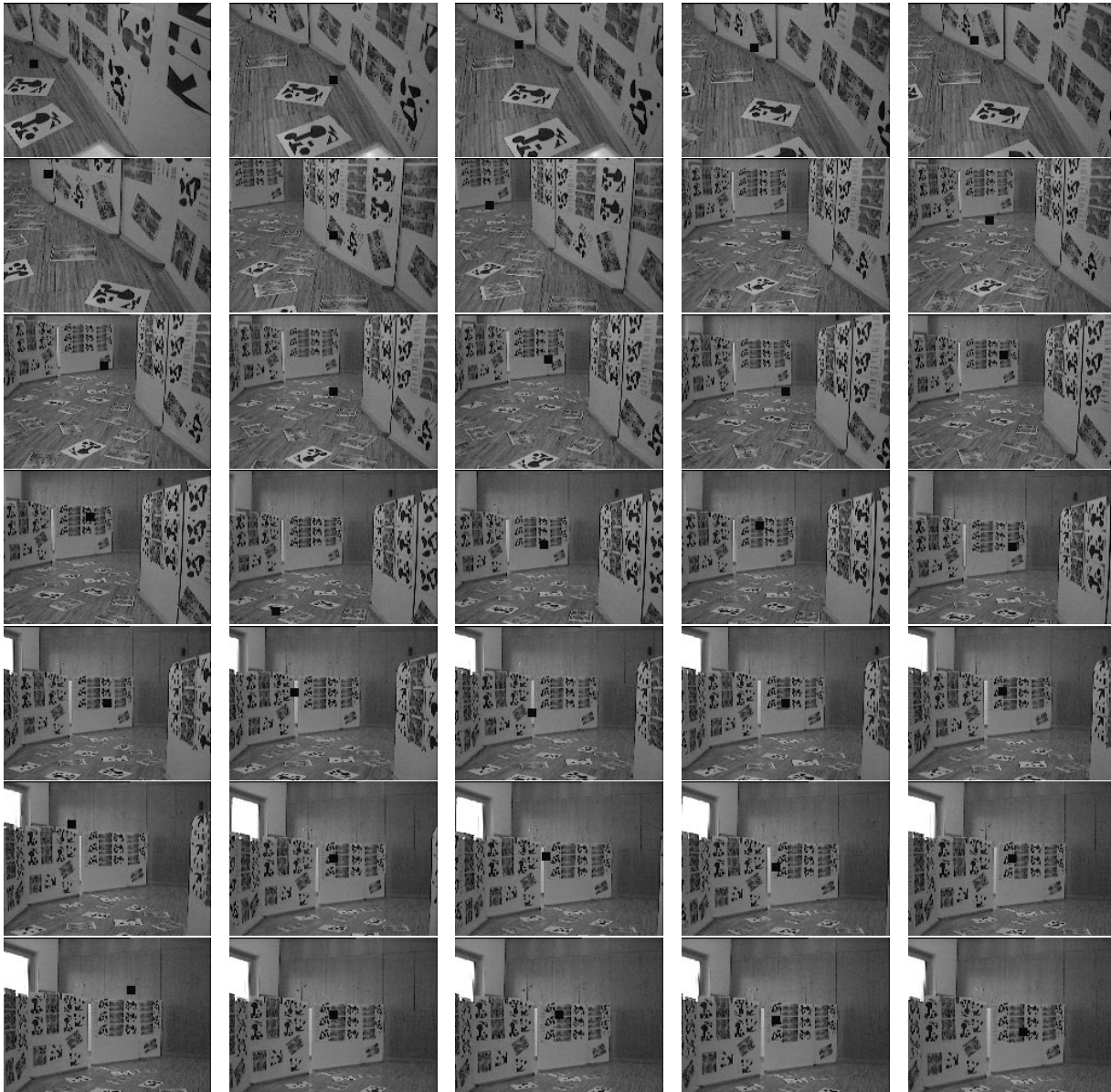
Figura 4.16: Sequência de alinhamento de uma câmara com o vector de movimento translacional de um robot. O ponto a preto indica a posição do FOE detectado na imagem log-polar que foi depois reconvertido para a imagem cartesiana.
