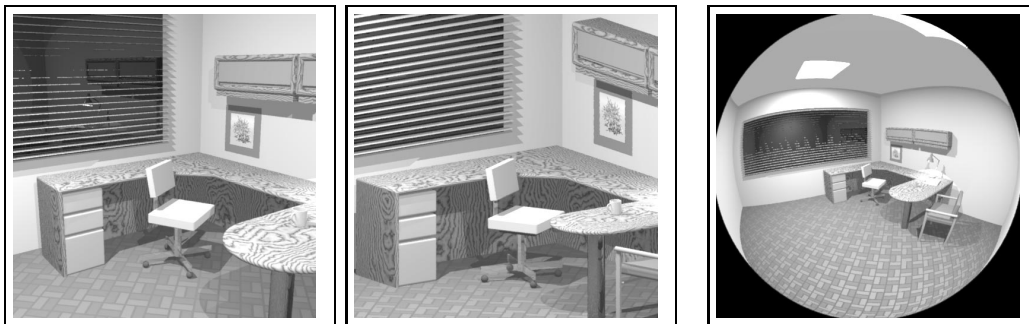
Figura 2.2: Imagens sintéticas geradas por (da esquerda para a direita): modelo geométrico, modelo ortográfico, modelo semi-esférico. As respectivas equações do modelo são dadas por: u = X.S_u , v = Y.S_v para o modelo ortográfico e por u = X_s.S_u , v = Y_s.S_v para o modelo semi-esférico, onde X_s = X \frac{r}{\sqrt{(X^2+Y^2+Z^2)}} , Y_s = Y \frac{r}{\sqrt{(X^2+Y^2+Z^2)}} e Z_s = Z \frac{r}{\sqrt{(X^2+Y^2+Z^2)}} , sendo r o raio da esfera.
