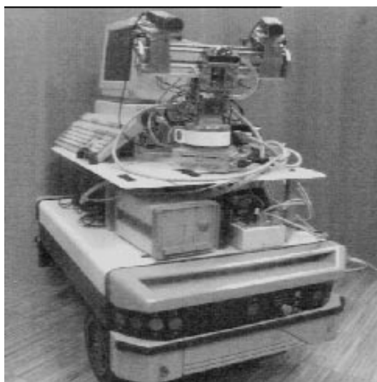
Figura B.2: O sistema de navegação autónomo com o sistema de visão activa, para desenvolvimento de tarefas baseadas em informação visual.
