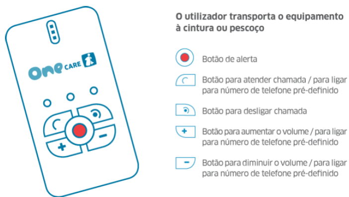
Figura 3.1: Esquema do funcionamento do OneCare Safe [45].
