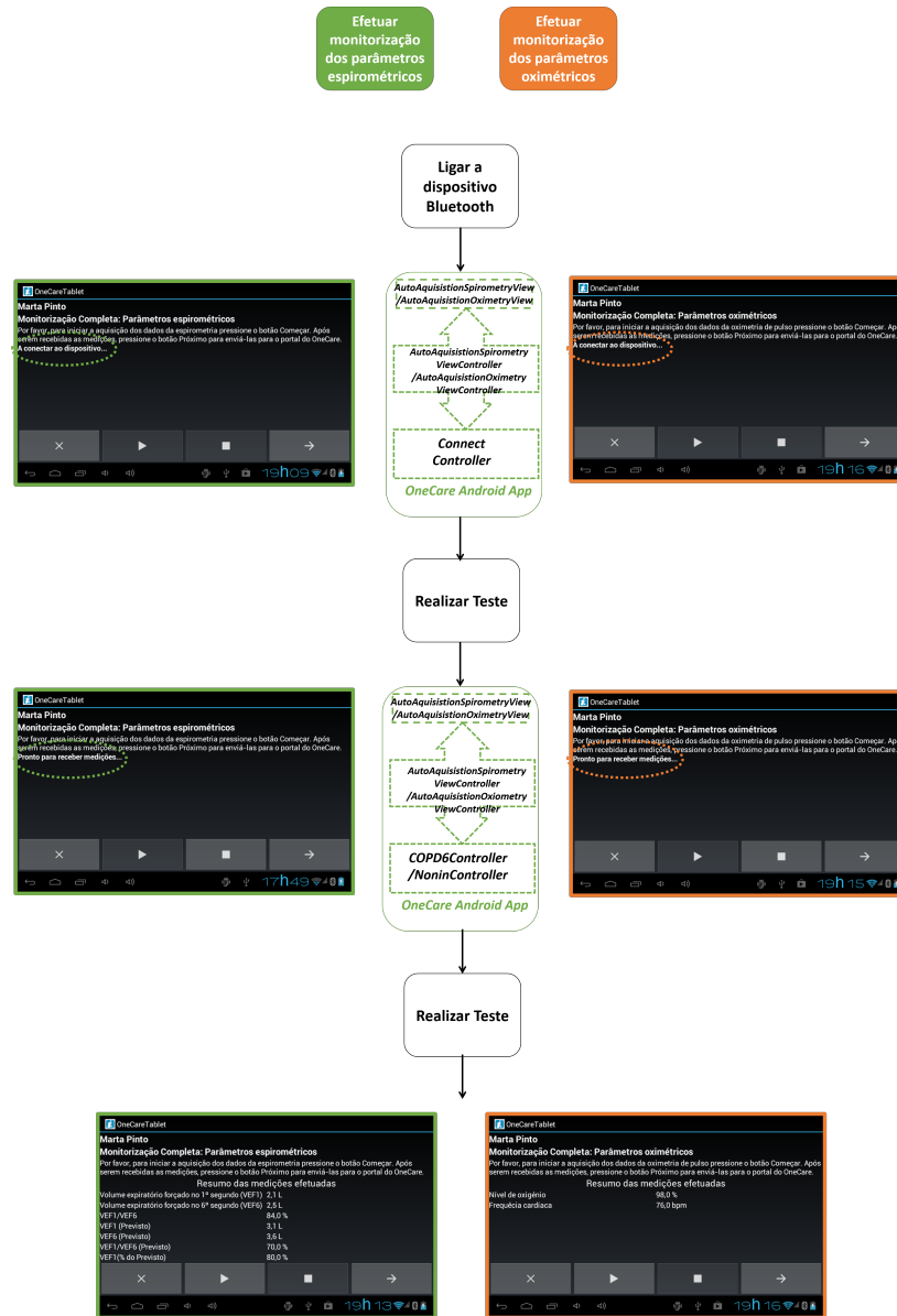
Figura 5.7: Fluxo de execução da aquisição automática dos parâmetros biomédicos: ligação ao dispositivo, realização e visualização das medições.
