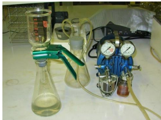
Figura 17. Sistema de filtração Buchner ligado à bomba de vácuo.
