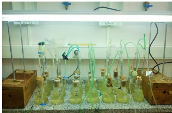
Figura 20. Condições de crescimento (intensidade luminosa de 43,24\mu\text{mol m}^{-2} \text{s}^{-1} , temperatura de 23°C, fotoperíodo de 16h:8h luz/escuro e borbulhamento de ar) das culturas a fim de se obter uma curva de crescimento de H. pluvialis .
