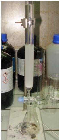
Figura 25. Coluna cromatográfica de vidro preparada com éter de petróleo e sílica gel G-60.
