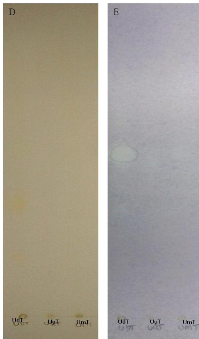
**Figura 9.** Perfil cromatográfico, por TLC após desenvolvimento e revelação com ácido acético a 15 %. (D) Observação à luz visível, com o revelador Neu/PEG; (E) Observação à luz visível, com uma solução do radical DPPH.
