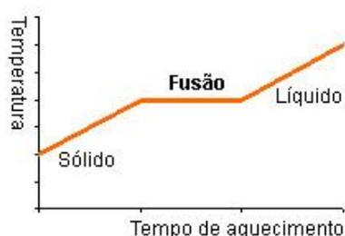
Gráfico 1 – Variação da temperatura de uma substância em função do tempo de aquecimento.
