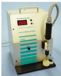
À semelhança do que acontece para a determinação do ponto de fusão, também existem aparelhos automáticos que permitem a determinação do ponto de ebulição, em poucos segundos, com precisão e exatidão superiores aos valores obtidos pelos métodos tradicionais.
