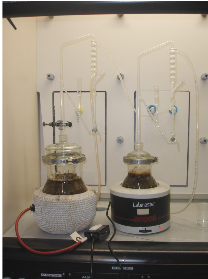
Figura 2 - Aparelho de Clevenger
