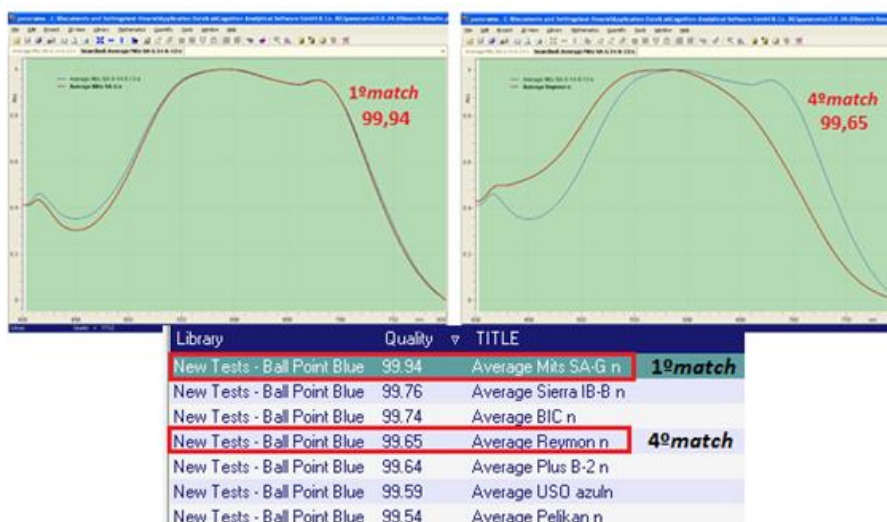
Figura C.5. De cima para baixo. Resultados obtidos quando parâmetro escolhido é a Derivada ao quadrado com normalização e sem normalização, G e H respectivamente. O espectro a vermelho representa as amostras inseridas na biblioteca das bases de dados, enquanto o espectro a azul representa a amostra desconhecida.
