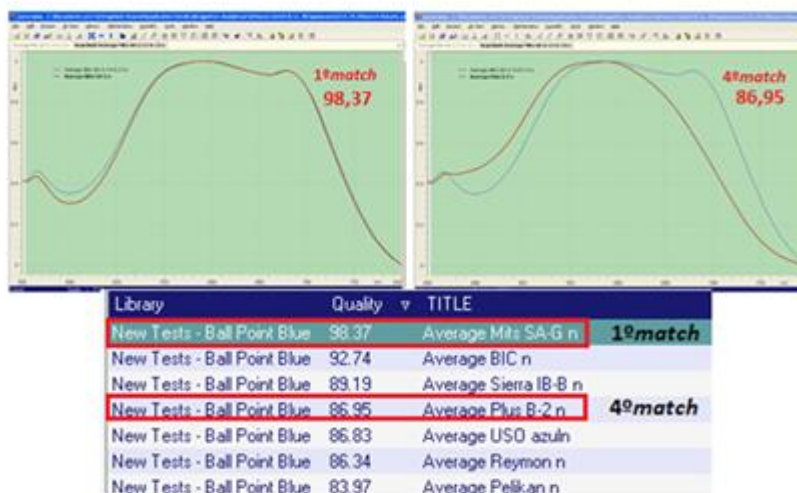
Figura C.2. De cima para baixo. Resultados obtidos quando o parâmetro escolhido é a Diferença com e sem normalização, A e B respectivamente. O espectro a vermelho representa as amostras inseridas na biblioteca das bases de dados, enquanto o espectro a azul representa a amostra desconhecida.
