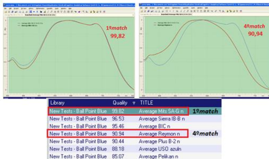
Figura C.7. De cima para baixo. Resultados obtidos quando parâmetro escolhido é a Derivada do Coeficiente de Correlação com e sem normalização, K e L respectivamente. O espectro a vermelho representa as amostras inseridas na biblioteca das bases de dados, enquanto o espectro a azul representa a amostra desconhecida.
