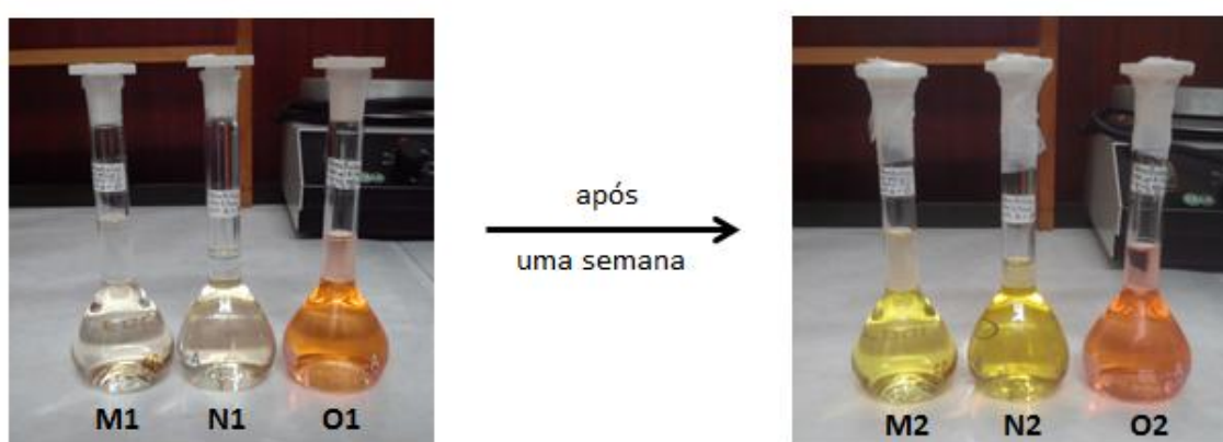
Figura 2.4. Soluções teste da Hematoxilina em que M1, N1, O1 correspondem às soluções preparadas no dia enquanto M2, N2, O2 correspondem as mesmas mas passado uma semana.
