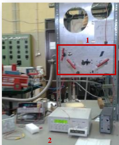
Figura 16 - Sistema volumétrico para adsorção de CO 2 onde se pode observar, 1, as válvulas de operação do sistema e a câmara onde fica introduzida a amostra, 2, os instrumentos de medida.
