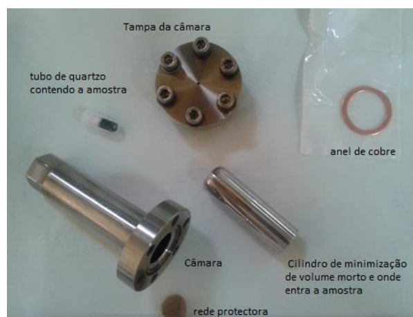
Figura 18 - Câmara onde é inserida a amostra e respetivas peças.
