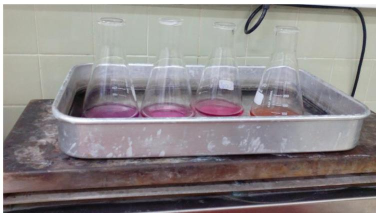
**Figura 3.6** – Determinação do índice de permanganato em amostras de água.
