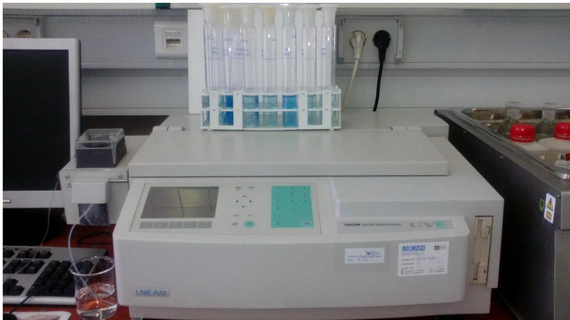
**Figura 3.5** – Determinação do azoto amoniacal em águas para consumo humano.
