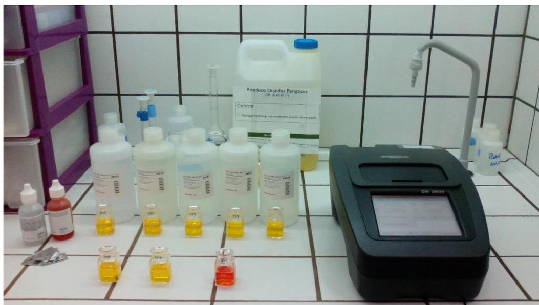
**Figura 3.3** – Determinação do manganês em águas para consumo humano.
