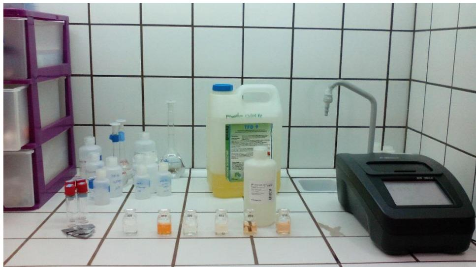
**Figura 3.2** – Determinação do ferro em águas de consumo humano, com digestão prévia.
