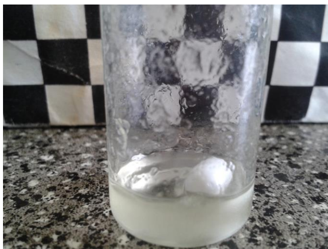
Figura 2.14. Imagem de uma amostra de 2% Avicel PH-101 75% DMSO 25% TMAH.
