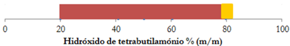
Figura 2.17. Limite de dissolução TBAH liofilizado, após dissolução, com 5% Avicel PH-101
