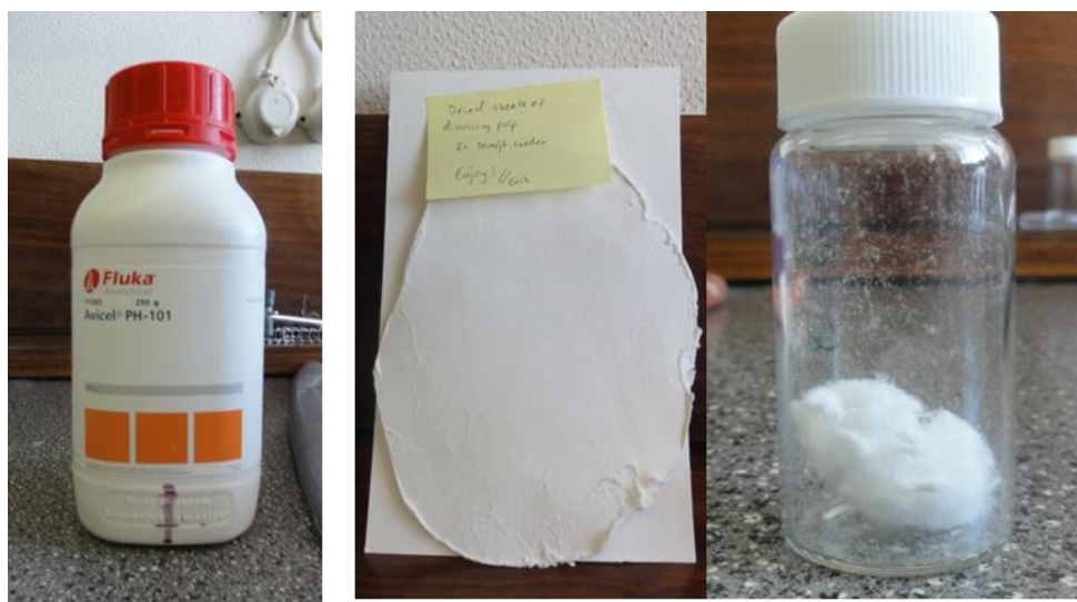
(a) (b) Figura 4.1. (a) celulose microcristalina Avicel; (b) polpa de papel da fábrica sueca Domjö
