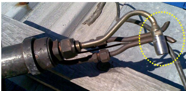
**Figura 4.13** – Detalhe de um bocal de amostragem
