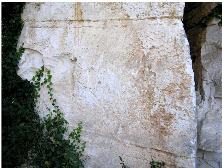
Figura 3. Aspeto de campo da fácies carbonatada esbranquiçada da “Pedra de Ançã”, num afloramento situado junto ao vale da ribeira de Ançã. Nesta área existem estratos calcários com uma espessura e espaçamento entre diaclases que possibilitam a extração de grandes blocos, com tamanhos comparáveis às dimensões da arca tumular gótica da Rainha Santa Isabel (foto dos autores).
