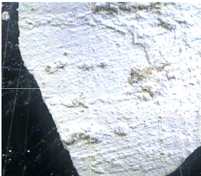
Figura 3. Pintura branca da amostra RN2527: a) difractograma da amostra: a – calcite, b – rutilo; b) imagem da superfície analisada; c) espectro de XRF evidenciando Ca, Ti, Zn, Fe, Sr, Cu e Pb (não se apresentam os elementos de baixa massa atômica).
