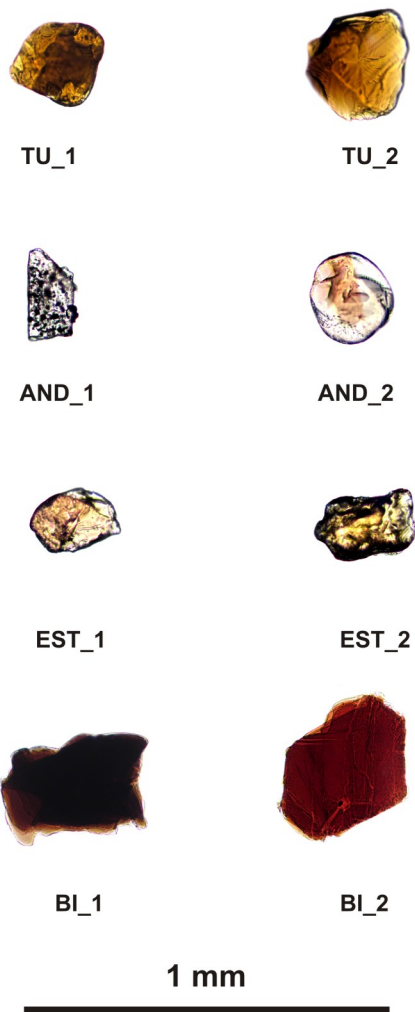
Figura 7. Aspecto visual de alguns grãos de turmalina, andaluzite, estauroлите e biotite identificados nas amostras oriundas da área envolvente ao cabo de Sines. TU_1 – turmalina sub-rolada, TU_2 – turmalina subangulosa, AND_1 – andaluzite angulosa, AND_2 – andaluzite sub-rolada, EST_1 – estauroлите sub-angulosa, EST_2 – estauroлите sub-rolada, BI_1 – biotite sub-rolada, BI_2 – biotite subangulosa (quase euédrica).
