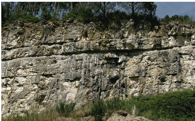
Figura 6. Uma das muitas pequenas pedreiras abertas junto à estrada nacional de Ançã - Cantanhede. Os estratos carbonatados da unidade dos "Calcários de Ançã" são aqui explorados para cantaria e pedra de calçada (altura máxima da frente é de 8 m) (foto dos autores).
