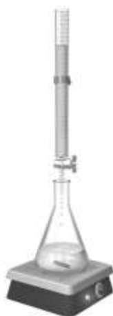
Figura 2.1 Montagem típica para a realização de uma titulação volumétrica. (Adaptado de [9])
