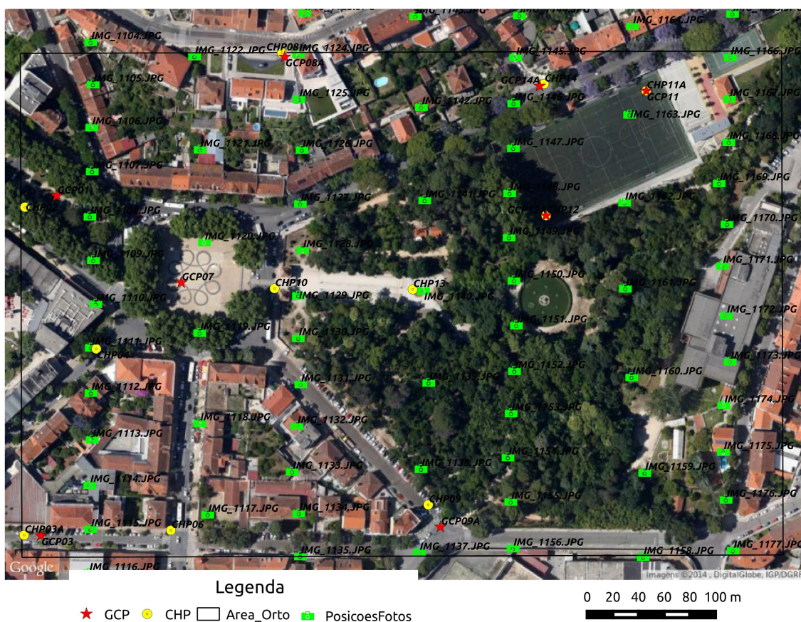
Figura 5: Localização da zona de estudo, dos centros das imagens e dos pontos de apoio e verificação
