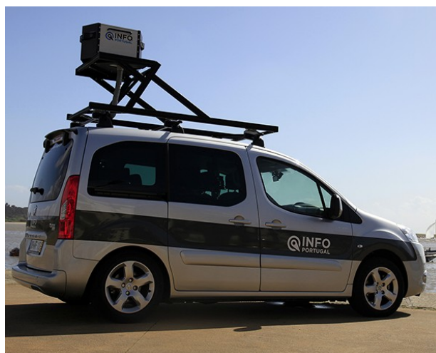
Figura 11: Trimble MX1 com a sua correspondente aplicação num veículo
