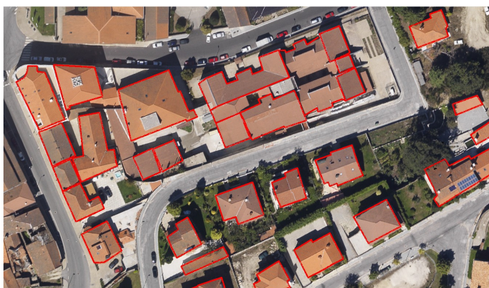
Figura 29: Vectorização sobre nuvem de pontos - vista Aérea
