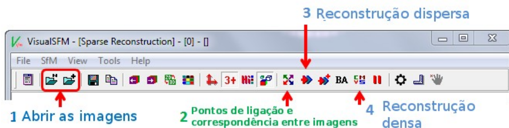
Figura 20: Passos para a realização da nuvem de pontos (Adaptado de (Wu, n.d.) )
