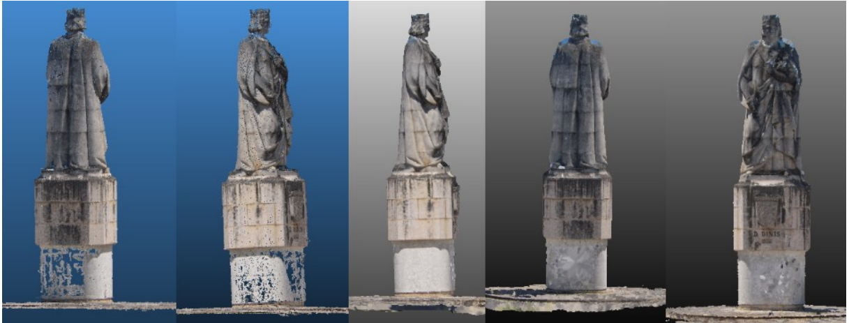
Figura 24: Resultado final, da esquerda para a direita, as duas perspectivas são referentes às nuvens de pontos, as restantes à construção da malha
