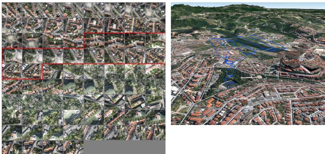
Figura 6: Bloco de 76 imagens que compõem a cobertura aérea da área de estudo e correspondente trajectória. A vermelho imagens utilizadas na calibração inicial da câmara.
