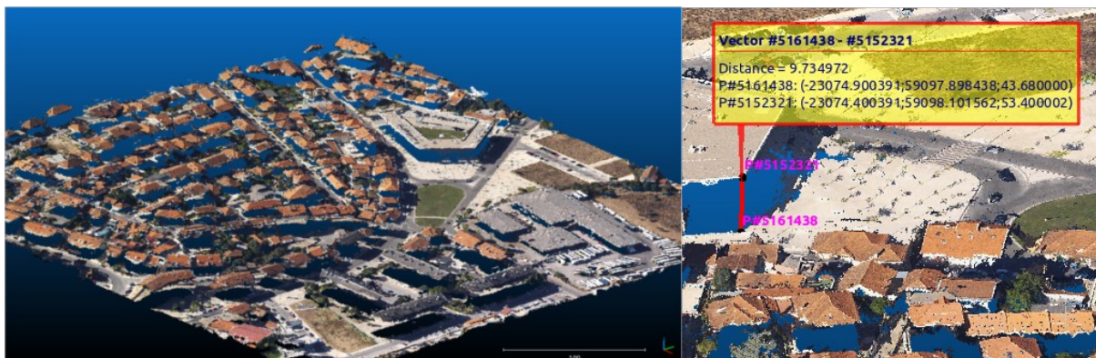
Figura 19: Nuvem de pontos de uma porção do projecto à esquerda, pormenor à direita
