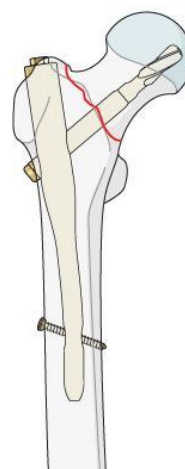
Figura 3 – Esquema ilustrativo do posicionamento do PFNa no fémur Adaptado de Schipper I, et al., 2004 (25)
