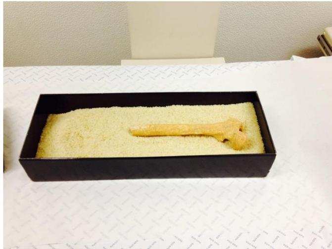
**Figura 3.** Posicionamento do fêmur na caixa de arroz para a realização da análise densitométrica (DXA).
