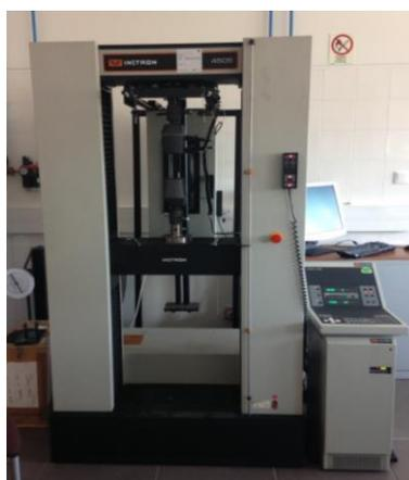
**Figura 42 – Equipamento utilizado nos testes de tração**
