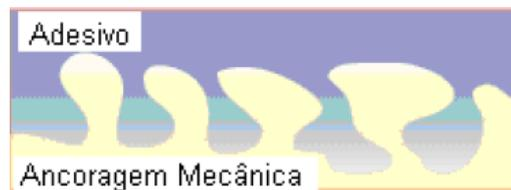
Figura 11 – Representação esquemática da teoria mecânica[28]
