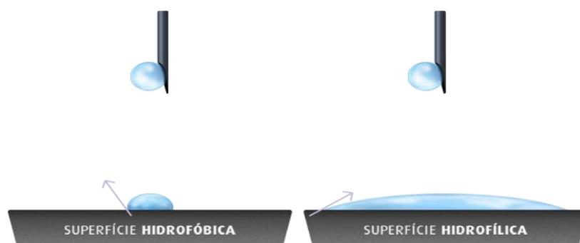
Figura 36 – Representação esquemática de uma superfície hidrofóbica e hidrofílica
