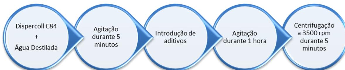
Figura 22 – Método de preparação de amostras
