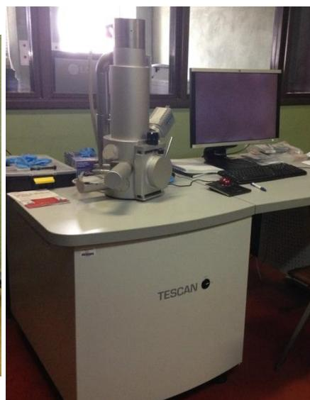
Figura 39 –Equipamento usado nas análises de SEM.
