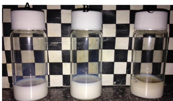
Figura 52 – Efeito da adição de 0,5% (imagem A), 2,5% (imagem B) e 5% (imagem C) de Hydropalat WE 3650 a uma solução com 55% de Dispercoll C84. A amostra com 5% de Hydropalat apresenta separação de fase.
